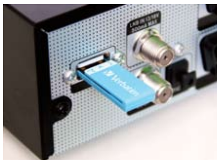
La porta USB è utilizzata per aggiornare il firmware e per trasferire i setting attraverso Pen Drive e hard disk esterni. Il backup e il restore delle liste canali semplificano il lavoro dell'installatore alle prese con un ampio parco macchine, ad esempio in alberghi, condomini, ecc. I setting dual-feed (19+13 Est) sono scaricabili gratuitamente dal sito web di Nord Est
