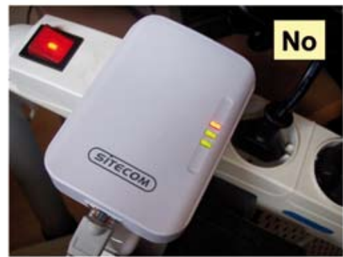
Figura 4. Gli adattatori Powerline vanno inseriti direttamente nella presa a muro evitando l'utilizzo di ciabatte multi-presa
