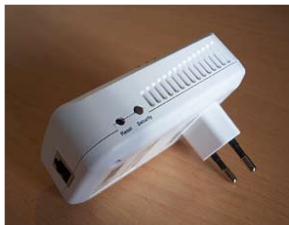
Figura 6. I pulsanti di reset e security nell'adattatore Powerline
