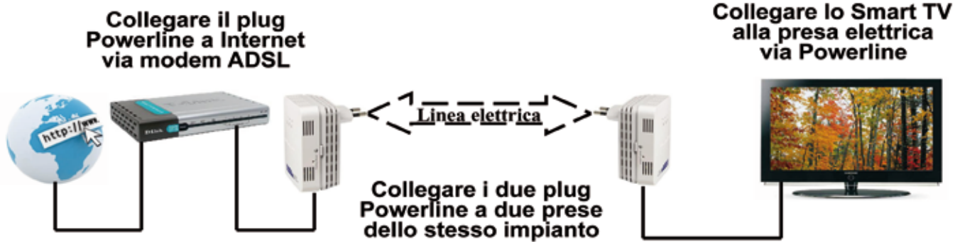
Figura 5. Le fasi di collegamento di un modem ADSL/router al televisore attraverso la rete Powerline
