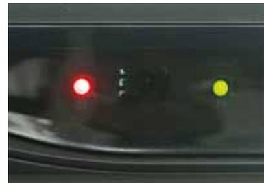
Sulla destra del pannello frontale si trovano due LED di stato e il sensore per la ricezione dei segnali IR del telecomando. I LED s'illuminano quando il decoder è in stand-by (rosso) e quando è acceso (verde)
