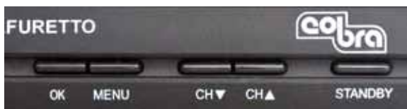
Il pannello comandi posizionato sul pannello frontale comprende 5 tasti: OK, Menu, CH+/CH- (zapping) e Stand-by
