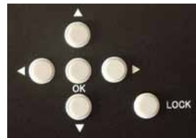
Il pannello comandi è composto da 6 tasti (freccette, OK e Lock) necessari per la programmazione manuale ed il controllo delle impostazioni utilizzando come feedback il display LCD
