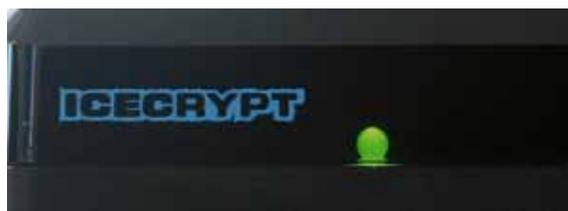
**L'unica spia attiva sul pannello frontale è il LED bicolore che si illumina di rosso in stand-by e di verde quando il decoder è operativo. Condividiamo la scelta dei progettisti di eliminare anche i tasti freccia ma un piccolo pulsante On/Stand-by sarebbe stato comunque utile**
