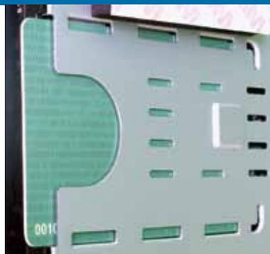
**Lo slot smart card è sistemato ai piedi del pannello frontale, praticamente a contatto con la parete inferiore dello chassis, per risparmiare spazio all'interno del decoder**
