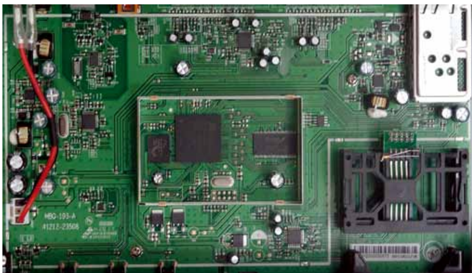
Tutti i circuiti elettronici - alimentazione, tuner, logica, decodifica, pannello comandi, ecc. - sono ospitati su un solo PCB, una soluzione che evita l'impiego di flat-cable, migliora l'affidabilità e facilita l'assemblaggio, tra l'altro molto curato. Al centro, racchiuse in un box metallico, troviamo la CPU STI 5107 e le memorie SDRAM e Flash; in alto a destra il tuner DVB-S Sharp; in basso a destra il doppio lettore smart card; a sinistra i componenti dell'alimentazione (stadio di bassa tensione). In alto si notano i connettori audio/video/dati con le due Scart schermate singolarmente mentre in basso i tasti del pannello comandi, il led bicolore e il sensore IR del telecomando
