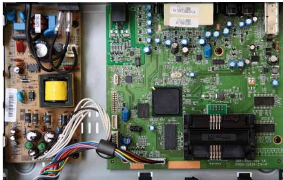
Lo spazio interno del decoder è occupato da tre circuiti stampati di cui due fissati sul fondo e un terzo dietro al pannello frontale e quindi non visibile nella foto. Il PCB di colore beige ospita i componenti dell'alimentatore switching, mentre quello verde è il "cuore" del decoder, ossia la motherboard. Su quest'ultima si notano la CPU ARM CX24155 affiancata dalle memorie Flash/SDRam, il tuner DVB-S (in alto a destra), le prese A/V con la doppia Scart schermata da un box metallico (in alto), il doppio lettore smart card (in basso). Sul terzo PCB trovano posto il display, i LED, il sensore IR del telecomando e i due tasti del pannello comandi. Sia l'assemblaggio sia i collegamenti tra i vari PCB sono realizzati con cura
