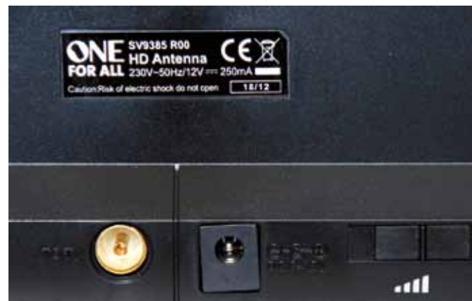
Alla base del pannello posteriore troviamo la presa antenna IEC dorata, il jack coassiale di alimentazione e il regolatore del livello di amplificazione su 4 posizioni
