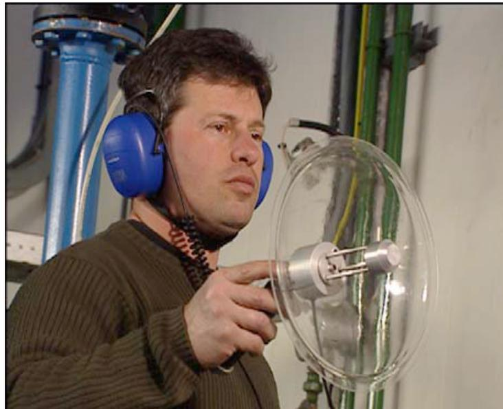
Noi abbiamo praticamente monitorato ( sotto la vostra supervisione) la quasi totalità della vostra rete di distribuzione grazie ad uno strumento di rilevazione delle fughe d'aria che misura gli ultrasuoni generati da un flusso di aria compressa che fuorisce anche da una piccola fessura presente sull'impianto di distribuzione. Le reti di distribuzione sotterranee o coibentate non possono essere individuate attraverso questa metodologia.
