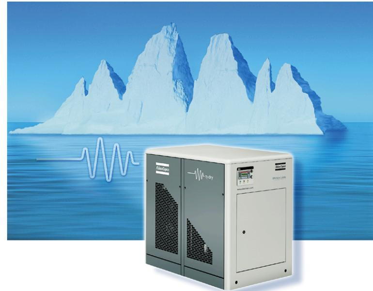
La tecnologia VSD negli essiccatori FD, consente un **risparmio energetico** grazie al sistema di regolazione Elektronikon che varia la velocità del compressore refrigerante, in funzione del livello del carico sull'essiccatore, mantenendo di conseguenza costante il punto di rugiada.
