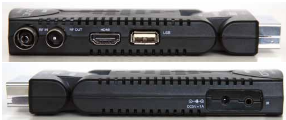
La spina Scart integrata invia i segnali video CVBS/RGB a definizione standard (576i) e audio analogici a TV, VCR, DVD-R, ripetitori di segnale e modulatori. La porta HDMI è invece l'unica "sorgente" in Alta Definizione nei formati 720p, 1080i o 1080p (ma supporta anche le risoluzioni SD 576i/p), garantendo i migliori risultati soprattutto con i contenuti HD nativi. La porta HDMI mette inoltre a disposizione il flusso audio digitale elettrico compatibile AC3/PCM per la successiva decodifica tramite Tv o sintoamplificatore Home Theater. Le due uscite AV faticano a operare contemporaneamente e una tende a escludere l'altra. Sullo stesso lato della HDMI troviamo anche le prese antenna IEC (ingresso e uscita passante), la USB in formato standard (tipo A) mentre su quello opposto il mini-jack del ripetitore IR e la presa coassiale di alimentazione
