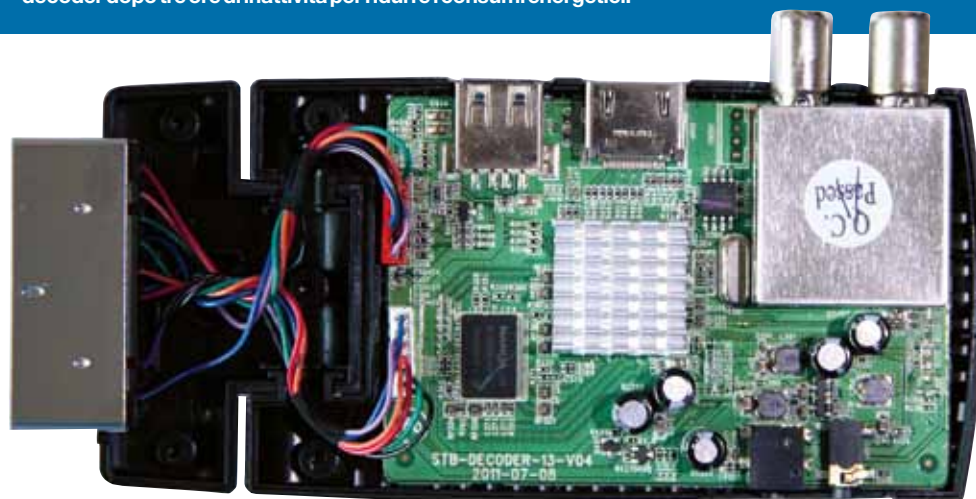
La mainboard misura solo 8,5x6 cm, è di tipo dual-side (doppia faccia) e ospita tutta la componentistica del decoder. Come è facile notare, la CPU concentra gran parte delle funzionalità ed è posizionata al centro, nascosta dal dissipatore di calore. In alto si notano le porte USB e HDMI, il controller HDMI (chip quadrato) e il tuner DVB-T mentre a sinistra della CPU è visibile la memoria Flash/SDRam. Dalla mainboard partono 12 fili colorati destinati alla SCART, divisi in due gruppi per facilitare la rotazione della spina
