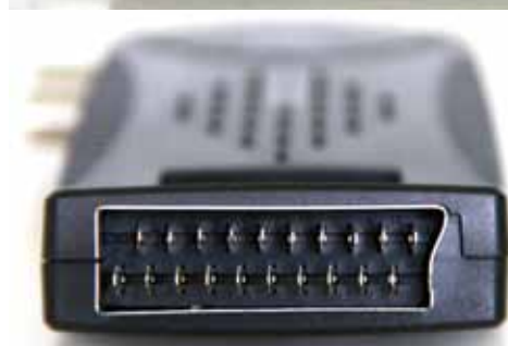
La spina Scart integrata invia i segnali video CVBS/RGB a definizione standard (576i) e audio analogici a TV, VCR, DVD-R, ripetitori di segnale e modulatori. La porta HDMI è invece l'unica "sorgente" in Alta Definizione nei formati 720p, 1080i o 1080p (ma supporta anche le risoluzioni SD 576i/p), garantendo i migliori risultati soprattutto con i contenuti HD nativi. La porta HDMI mette inoltre a disposizione il flusso audio digitale elettrico compatibile AC3/PCM per la successiva decodifica tramite Tv o sintoamplificatore Home Theater. Le due uscite AV faticano a operare contemporaneamente e una tende a escludere l'altra. Sullo stesso lato della HDMI troviamo anche le prese antenna IEC (ingresso e uscita passante), la USB in formato standard (tipo A) mentre su quello opposto il mini-jack del ripetitore IR e la presa coassiale di alimentazione
